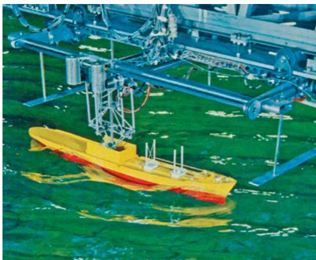
МОДЕЛЬ КОРАБЛЯ полутораметровой длины проходит испытания в волновом бассейне, 1959 г.
